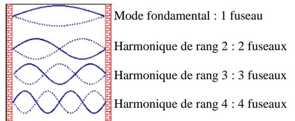
Pour étudier les différents paramètres de la corde pouvant influencer la fréquence fondamentale, on utilise un dispositif expérimental appelé « **corde de Melde** ».
